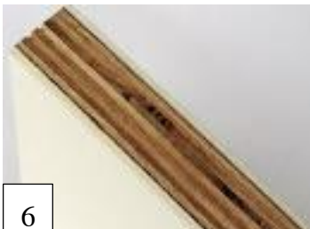
شكل رقم (7) يوضح الأنواع المختلفة للنواة الأساسية لألواح الساندوتش (1 مواد رغوية - 2 فوم - 3 صفائح مموجة - 4 خلية نحل هاني كومب) ورقية - 5 خلية نحل هاني كومب) من الألومنيوم - 6 الخشب
